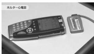
ホルター心電図は、患者に携帯型の心電図記録計を装着してもらい、24時間の心電図をICメモリーなどに記録し、測定する検査で、
